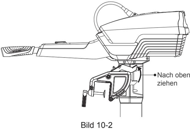
**Schritt 2:** Lassen Sie die Fixierung los, der Hebel für die Schwenkfunktion bleibt nun in der oberen Position. Der Außenborder ist nun in Kipprichtung nicht fixiert.
