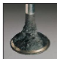
Ohne Marine Benzin-System-Reiniger: Ablagerungen an Ventilen, geringe Motorleistung.
